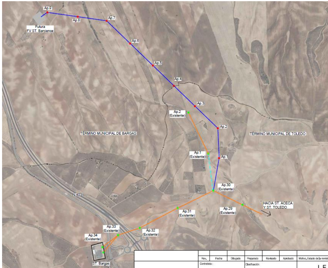
Figura 3. Emplazamiento línea de evacuación 132 kV
