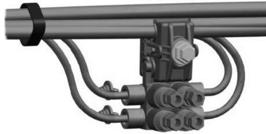
Figura 3. Detalle conexión, en este proyecto sólo se necesita un conector con 3 entradas
