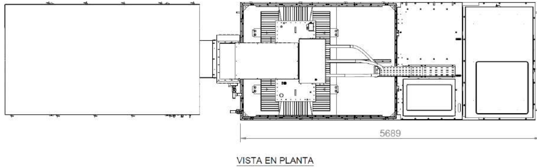
Ilustración 1. Planta de la powerstation
