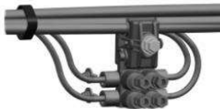
Figura 2. Detalle conexión, en este proyecto sólo se necesita un conector con 3 entradas
